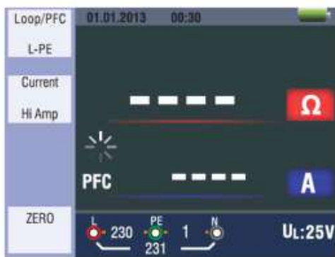
Рис. 7 Применение режима Hi Amp LOOP в цепи без УЗО
