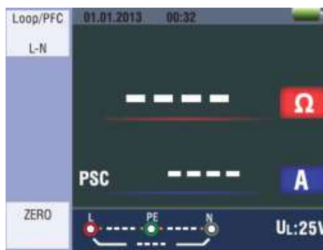
Рис. 10 Ожидание измерения сопротивления L-N
